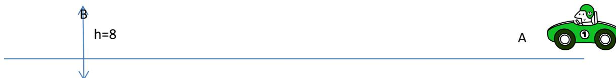
4.-Una ESFERA de 2kg se deja caer desde A dentro de una caja de arena desde 10m de altura sobre B como se aprecia en la figura. Se detiene 3cm debajo de la superficie de la arena. ¿Cuál será la fuerza de fricción promedio que la arena ejerce sobre ella? RESPUESTA= -3263.333N (Cambios de Energía)
